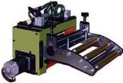
CNC ロール フィーダ 300LA-H (傾斜ガイド及び材料戻り装置仕様)
